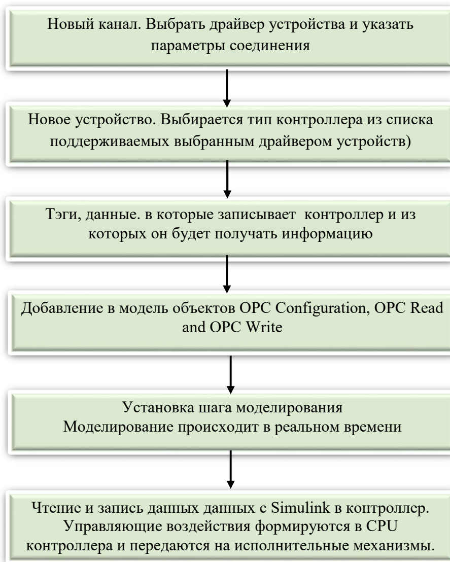
Рисунок 5.1 – Настройка работы OPC-сервера
